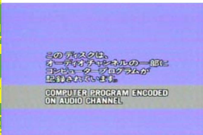
no computador, ao se solicitar o carregamento do LaserDisc, automaticamente o canal em que está gravado o programa é chaveado para que o MSX possa ler os dados, tal qual um carregamento de fita cassete, porém, de forma mais eficiente.
